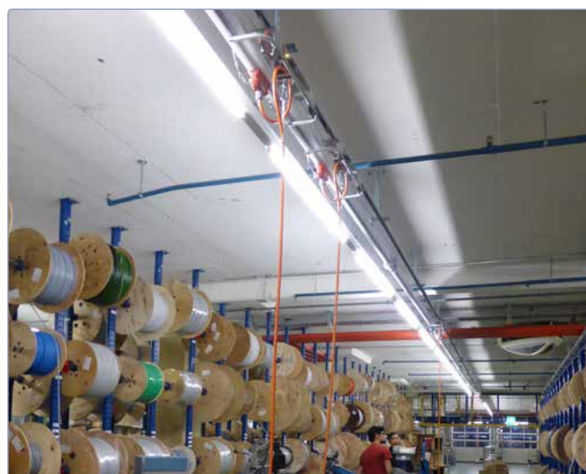
Systeme Stinger, ligne conductrice en combinaison avec l'installation de chariots de cables pour des machines de mise a longueur de cables
