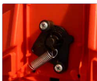
Blocage du câble à la longueur désirée
