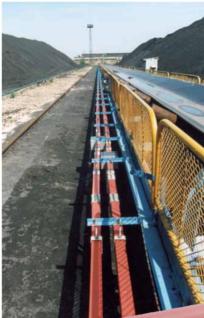
*AKAPP Multiconductor, le gaine sécurité possède un système unique basé sur la libre expansion du châssis et des conducteurs. Grâce à l'absence de connexions à fiches, les conducteurs offrent la transmission d'énergie et de signaux la plus fiable.*
