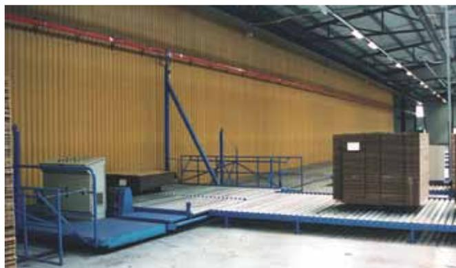
Gaine de rail type RN7 pour l'alimentation et la commande d'un chariot de traverse dans une fabrique de cartons.
