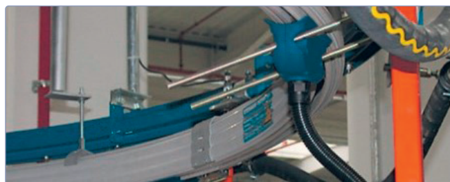
Beispiel Rundanlage, Mitnehmer mit Scharnier pendelnd und seitlichen Abweichungen
