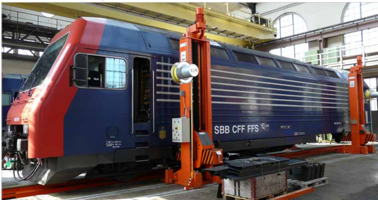
Ateliers CFF – colonnes de levage mobiles avec tambours de câbles H+K pour les travaux d'entretien ergonomiques et sûrs des locomotives des CFF
