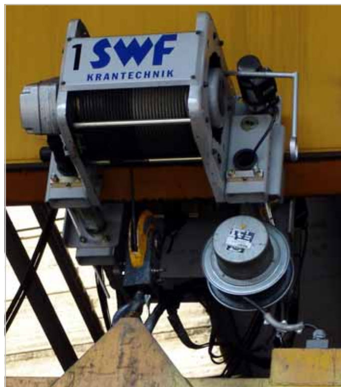
Tambours de câbles pour commande d'amorçage magnétique la solution économique pour l'alimentation d'un système de levage magnétique.
