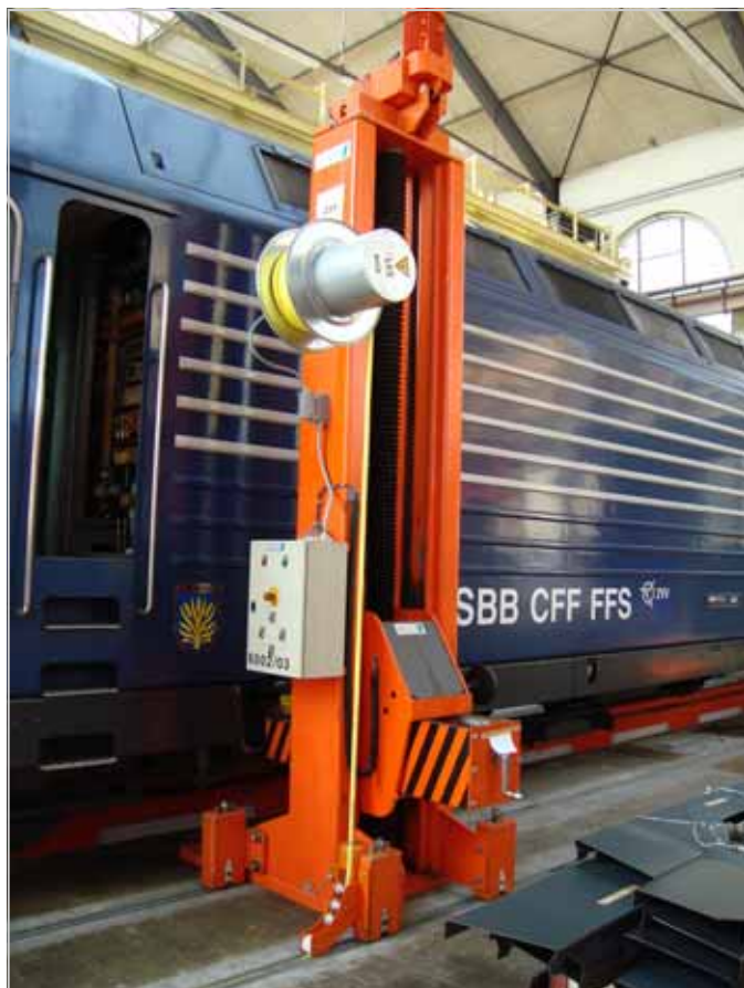
Ateliers CFF – colonnes de levage mobiles avec tambours de câbles H+K pour les travaux d'entretien ergonomiques et sûrs des locomotives des CFF
