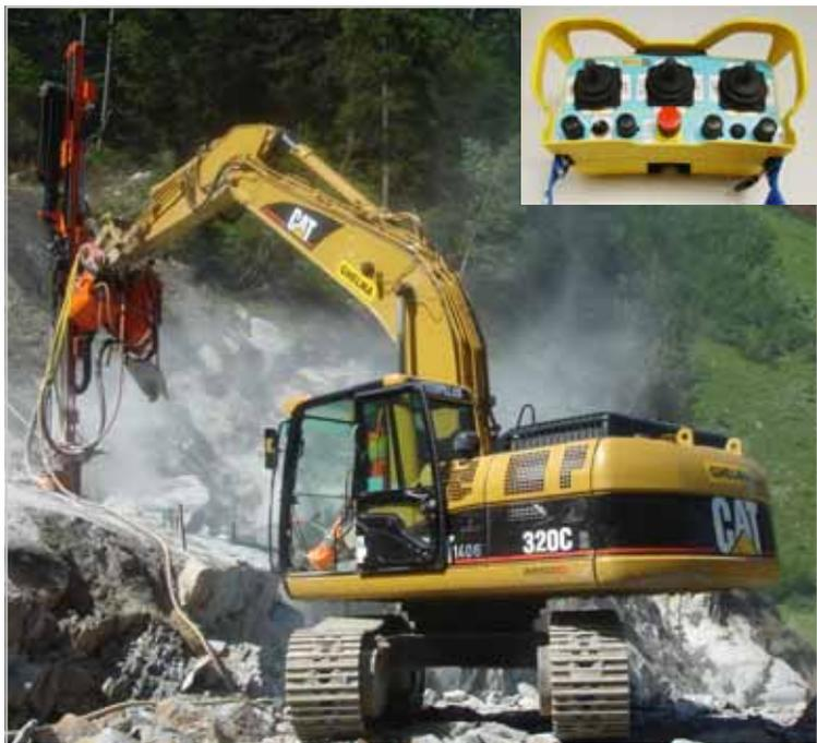
**Support pour forage monter sur un excavateur**
