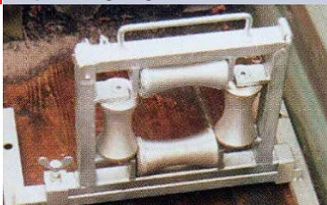
Dispositif de guidage de câble avec corps de galet et pied de support
