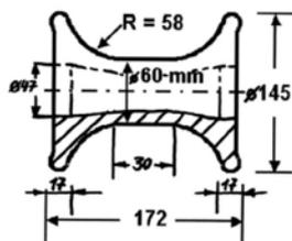
Ils sont utilisés pour la construction de tunnels comme alternative peu couteuse pour la pose du câble d'alimentation.
