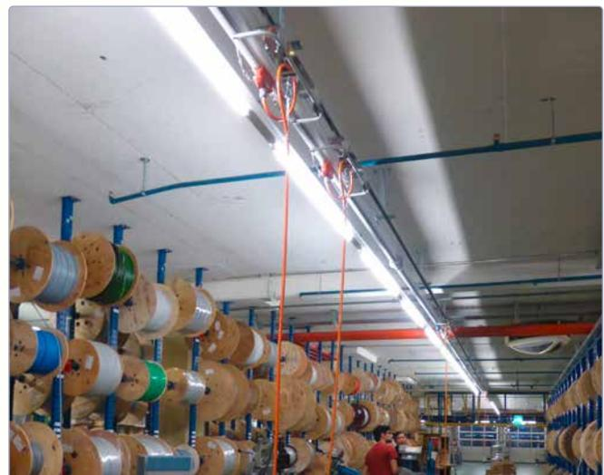
Stinger-System, Schleifleitung in Kombination mit Kabelwagenanlage für Kabelabläng-Maschinen
