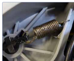
Blocage du câble à la longueur désirée
