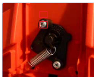
Blocage du câble à la longueur désirée
