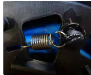
Blocage du câble à la longueur désirée
