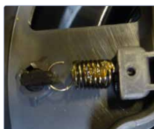
Blocage du câble à la longueur désirée
