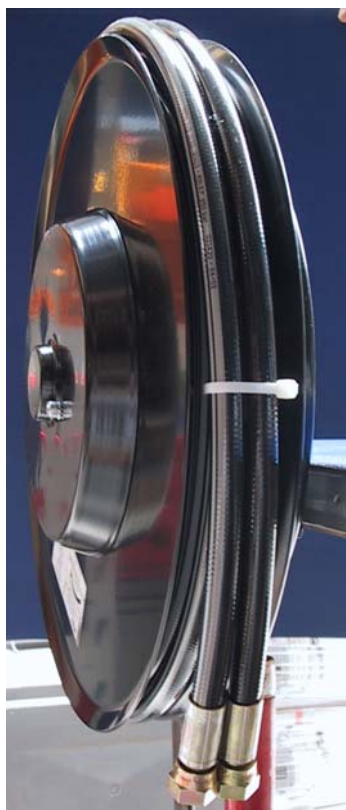
Hydraulikaufroller für Stapler etc. in Duo-Trio Systemen
